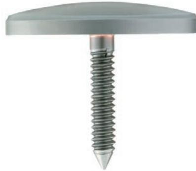
Pistolengriffkämpchen mit verdeckter Schaftschraube. Eine in der Unterseite des Pistolengriffkämpchens fest installierte Schraube wird in die dafür vorgesehene Gewindebuchse mittels eines Spezialschlüssels eingedreht. Das genaue Ausrichten erfolgt durch eine Stellungsänderung der Gewindebuchse. Unübersehbarer Vorteil: Grosse, homogene Gravurfläche.
