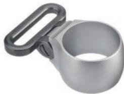
Classic-Ringriemenbügel für Repetierbüchsen. Kopfbreite: 6 mm; Bohrung:  $\varnothing$  3,0 mm; Ringbreite: 15,0 mm.
