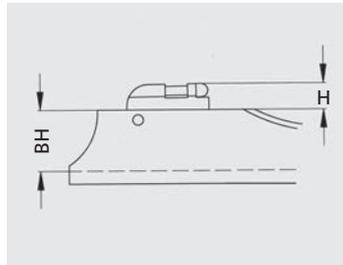
ATV-Kornsattel in verschiedenen Bauhöhen, mit und ohne Kornschutz-Sicherung, Lauffradius R 7,5 mm.
