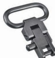
SECURA-Riemenbügelkörper mit eingebogener Drahtöse, für 6 mm Kopfbreite, Stift- $\varnothing$  3,0 mm, brüniert. Innenmaß: 27,0 x 7,0 mm.
