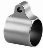
Ringriemenbügel in besonders schlanker Ausführung, zylindrisch. Kopfbreite: 8 mm; Bohrung:  $\varnothing$  3,6 mm; Ringbreite: 20,0 mm.
