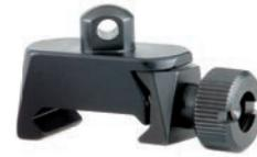
Riemenbügelhalter in drehbarer Ausführung und 8 mm breitem Kopf. Eine Feststellung des Riemenbügelkopfes ist nicht möglich. Die Befestigung auf der Weaver- bzw. Picatinny-Schiene erfolgt mittels Rändelschraube und federndem Gegendruck-Klemmschieber.
