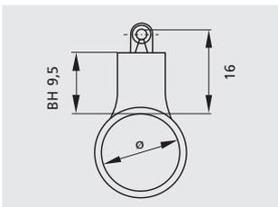
H&H-Ringkornsattel mit gerundeter Sichtfläche, Elfenbeinklappkorn  $\varnothing$  4 mm, H&H-Silberperlkorn  $\varnothing$  2 mm bzw. H&H-Lumifix-Korn  $\varnothing$  2,5 mm.
