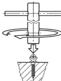
Dieser doppelseitig zu nutzende Formschlüssel bietet die Möglichkeit, alle von uns gefertigten Riemenbügel-Holzschrauben problemlos in den Schaft einzuschrauben und rechtwinklig auszurichten. Passend für 6 mm und 8 mm Kopfweite
