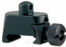
Riemenbügelhalter in dreh- und feststellbarer Ausführung mit 8 mm breitem Kopf. Die Feststellung erfolgt über einen seitlich sitzenden Gewindestift. Wird dieser bis zum Anschlag herausgedreht, ist der Riemenbügelkopf drehbar gelagert. Die Befestigung auf der Weaver- bzw. Picatinny-Schiene erfolgt mittels Rändelschraube und federndem Gegendruck-Klemmschieber.
