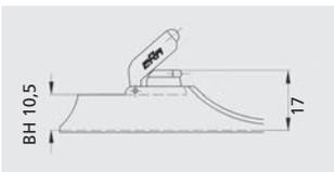
H&H-Kornsattel mit rundgeriffelter Sichtfläche, Elfenbeinklappkorn  $\varnothing$  4 mm, H&H-Silberperlkorn  $\varnothing$  2 mm bzw. H&H-LUMIFIX-Korn  $\varnothing$  2,5 mm.
