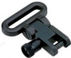
Riemenbügelkörper mit montierter Öse und Rändelmutter zur Sicherung gegen unbeabsichtigtes Öffnen. Für 6 mm Kopfbreite. Stift- $\varnothing$  3,0 mm, brüniert.
