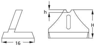
Visiere mit 16 mm breitem Prisma. Sie können in den Visiersattel 16005-2016 bzw. in die Ringvisiersattel 16510-0... und 16520-0... eingepasst werden. Ebenfalls geeignet sind diese für die Visiersattel 16015-2016 und 16017-2016 sowie den Ringvisiersattel 16530-0..., in denen sie mittels Klemmscheibe bzw. grosser Klemmbacke befestigt werden.
