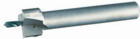
Mit dem Zapfensenker lässt sich die Bohrung für den äusseren Durchmesser der KDR-Buchse im Schaft herstellen. Der Spiralbohrer stellt den Kerndurchmesser für die Holzschraube her. Die Tiefe muss nachgebohrt werden.
