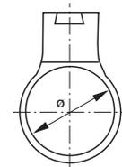
Ringkornsattel mit Längsprisma, aus einem Stück gefertigt, glatte Sichtfläche. Breite: 8,5 mm
