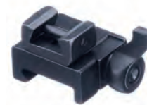
Aufkippmontage mit federnden Gegendruck-Klemmschiebern u. 70°-Aufnahmeprismen für Zielfernrohre mit Mittelrohrschiene.
