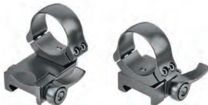
Aufkippmontage mit federnden Gegendruck-Klemmschiebern und schräggeteilten Ringen.
