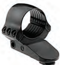
GK-Vorderringe mit Verlängerung. Der Klemmring sitzt in einer Verlängerung mit Pivotzapfen und wird mit zwei Innensechskantschrauben geklemmt. Mit Toleranzausgleich. Bauhöhe: 13,5 mm, Ringbreite: 22,0 mm
