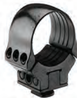
Vordere GK-Klemmringe in kurzer, besonders stabiler Ausführung, mit Toleranzausgleich. Der Klemmring sitzt in einer Aufnahme mit Pivotzapfen und wird mit drei Innensechskantschrauben geklemmt. Bauhöhe: 13,5 mm, Ringbreite: 22 mm
