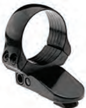
Vorderringe mit Verlängerung. Der Klemmring sitzt in einer Verlängerung mit Pivotzapfen und wird mit zwei Innensechskantschrauben geklemmt. Mit Toleranzausgleich. Bauhöhe: 13,5 mm, Ringbreite: 15,0 mm
