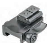
Aufkippmontage mit federnden Gegendruck-Klemmschiebern für Swarovski SR-Zielfernrohre mit Innenschiene und Zahnprofil.
