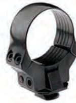
Vordere Klemmringe in kurzer Ausführung, mit Toleranzausgleich. Der Klemmring sitzt in einer Aufnahme mit Pivotzapfen und wird mit zwei Innensechskantschrauben geklemmt. Bauhöhe: 13,5 mm, Ringbreite: 15 mm
