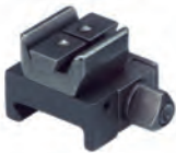
Aufkippmontage mit federnden Gegendruck-Klemmschiebern und 45°-Aufnahmeprismen.
