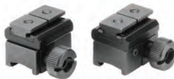
Aufkippmontage mit federnden, einstellbaren Gegendruck-Klemmschiebern für Swarovski SR-Zielfernrohre mit Innenschiene und Zahnprofil.
