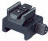
Aufkippmontage mit federnden Gegendruck-Klemmschiebern und 45°-Aufnahmeprismen.
