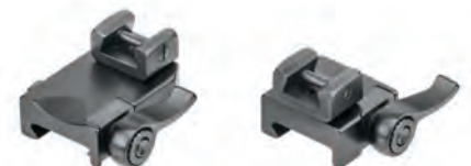
Aufkippmontage mit federnden Gegendruck-Klemmschiebern u. 70°-Aufnahmeprismen für Zielfernrohre mit Mittelrohrschiene.
